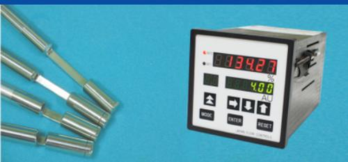
菌体の測定に最適な特性を示す近赤外線波長を採用したレーザー式濃度センサーです。
